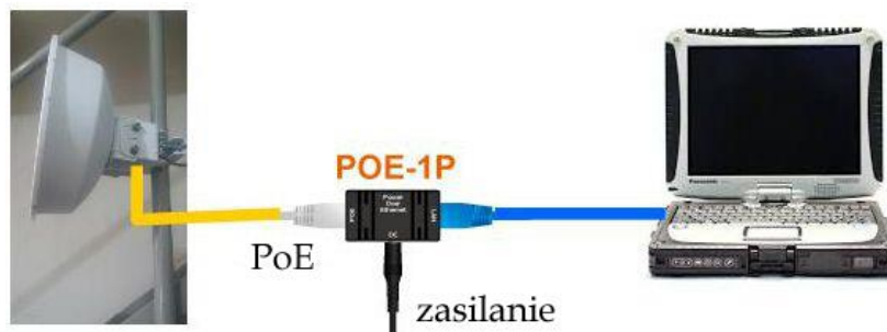
Rys. 11.2. Połączenie punktu dostępowego Ubiquiti, komputera i zasilania
