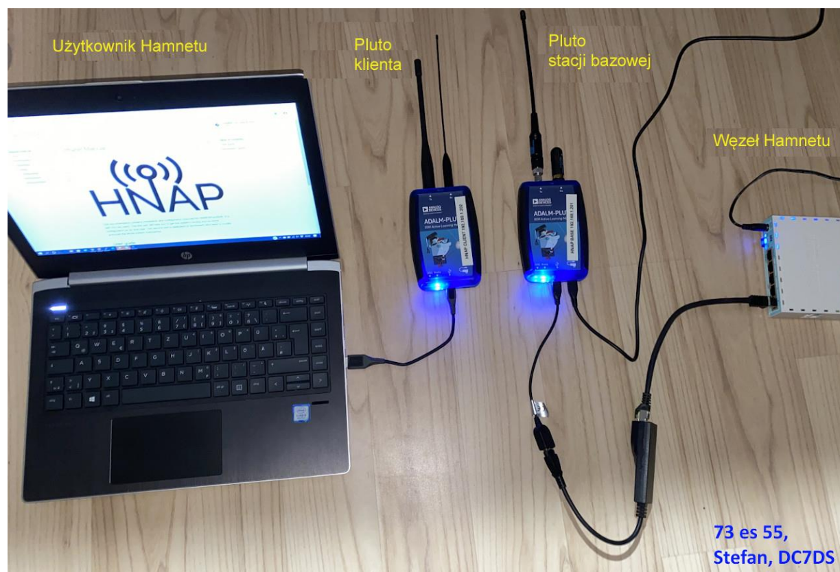
Fot. 10.1.5. Łącze z wykorzystaniem radiostacji „Adalm Pluto”
